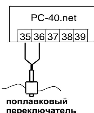
Поплавковый мини-переключатель монтируется на подвижном уголке, который затем прикручивается на желаемой высоте к крепежной планке вертикально закрепленной на стенке скиммера. Перемещая уголок вдоль крепежной планки можно выставить необходимый уровень воды. Фиксируется уголок с помощью крепежного болта. Все части очень хорошо подходят друг к другу, так что нет необходимости применения силы.
