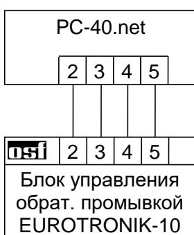
Для подключения блока управления обратной промывкой EUROTRONIK-10 требуется 4-х жильный кабель. При подключении нельзя перепутать провода. Блок EUROTRONIK-10 требует отдельного подключения к электросети
