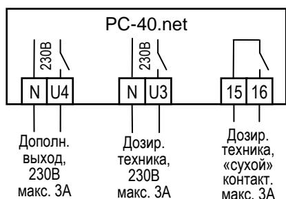
К клеммам U4 и N можно подключить дополнительное устройство 230В (например: подводный прожектор), который можно управлять собственным часовым реле. Также выход можно настроить в меню конфигурации на работу с дозирующим насосом для флокуляции.
