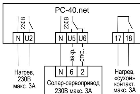
Для подключения водонагревателя в распоряжении имеются клемма U2. К этому выходу на 230В можно подключать нагрузку до максимум 3А.
