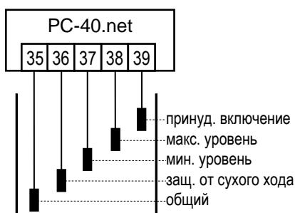
б) **Защита фильтрующего насоса от сухого хода.** Если уровень воды из-за промывки фильтров упадет ниже электрода «Защита от сухого хода» (клемма 36), то блок управления отключит фильтрующий насос, во избежание выхода его из строя из-за работы с недостаточным количеством воды. Насос будет отключен до тех пор, пока уровень воды в переливной ёмкости не достигнет электрода «мин.» (клемма 37).
